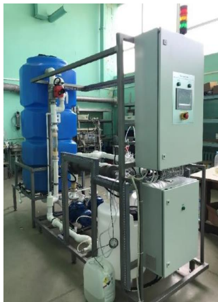
Пилотная установка на базе ТЕОД-реактора для исследования по очистке сточных вод от фенолов, красителей, ПАВ, аминов и другой органики. Размещается в 20-ти футовом контейнере
