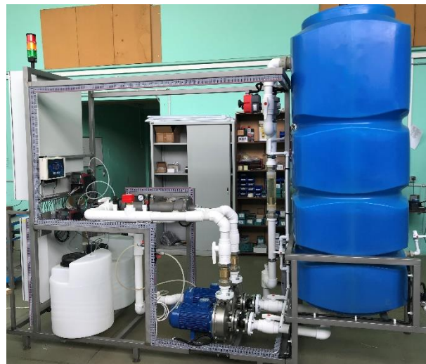
Пилотная установка на базе ТЕОД-реактора для исследования по очистке сточных вод от фенолов, красителей, ПАВ, аминов и другой органики. Размещается в 20-ти футовом контейнере
